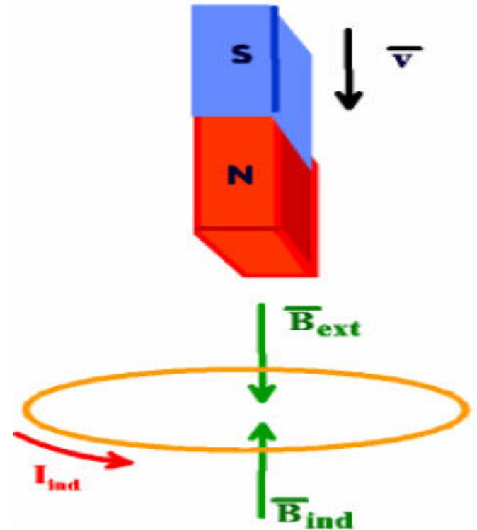
Le courant induit  $I_{\text{ind}}$  doit donc avoir un sens tel que le champ qu'il induit,  $\vec{B}_{\text{ind}}$  provoque une diminution du flux magnétique.
