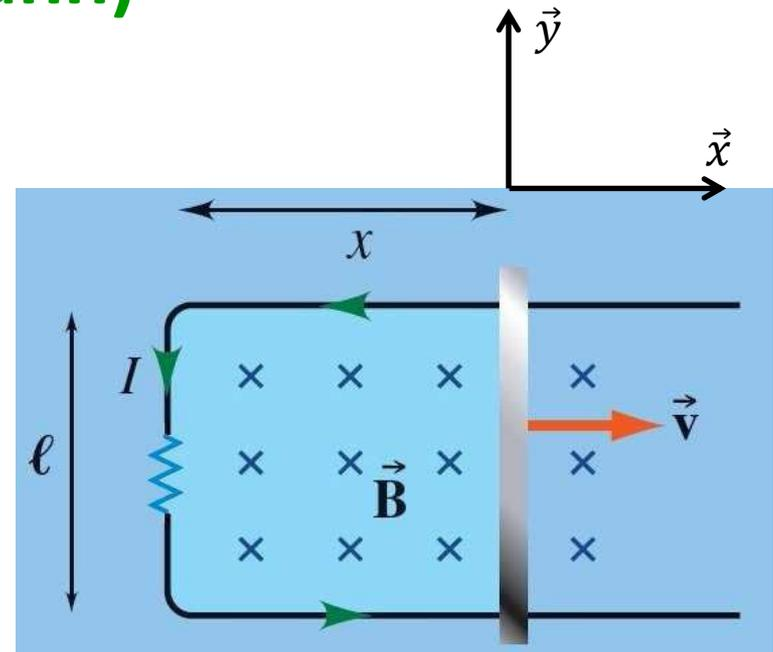
Dans cet exemple, le signe (-) dans l'expression signifie que le champ magnétique induit associé au courant induit est dans la direction inverse du champ magnétique extérieur. Cela permet de déterminer la direction du courant induit.
